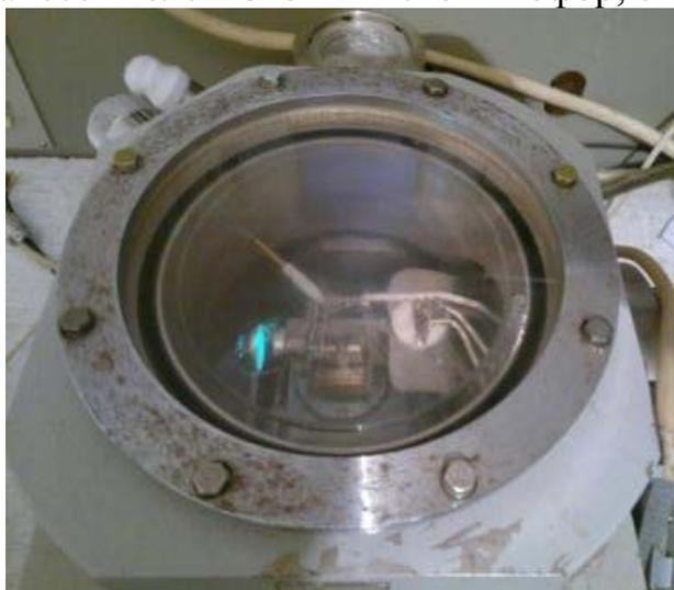
Рис. 1. Макет катодолюминесцентного источника света
