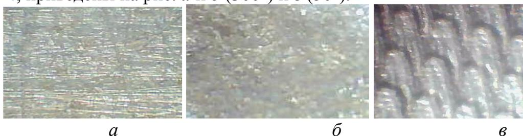
Рис. Изображение поверхности оксидированного алюминия: *а* — с осажденным пероксидом урана; *б* — то же, прогретое при 420 °С; *в* — то же, после обработки лазером по площади
