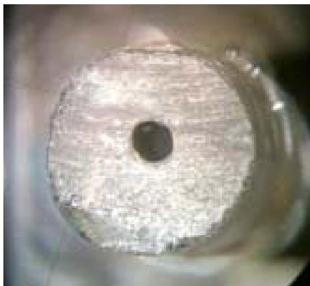
Рис.3. Фотография «стеклянного» катода (вид с торца)
