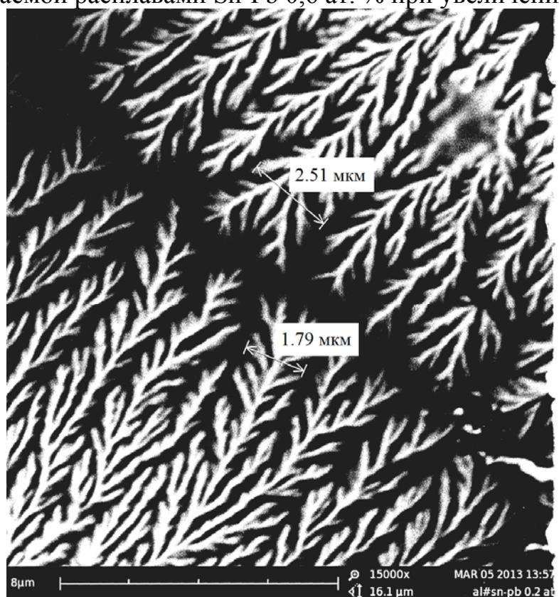
Рисунок 3. Фотография границы подложки алюминия смачиваемой расплавами Sn-Pb 0,2 ат. % при увеличении 15000<sup>×</sup>
