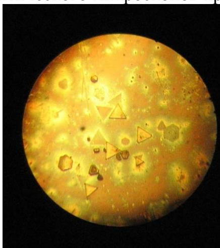
Рис. 1. Обзорная фотография МК галогенида серебра полученная с помощью оптического микроскопа VELOMET
