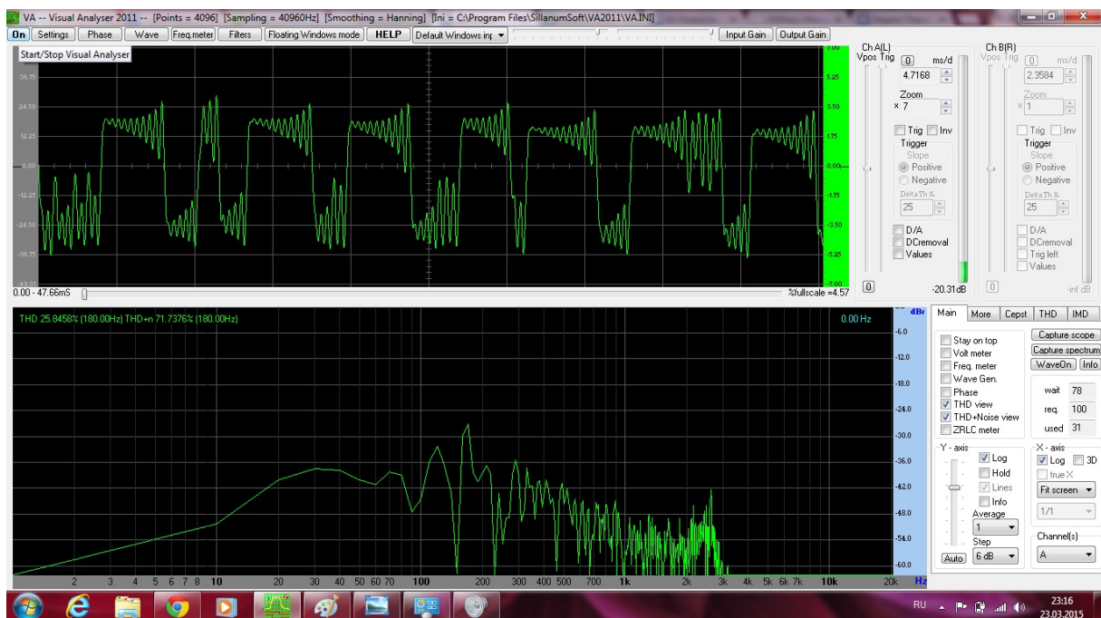
Рис. 2. Сигнал и его спектр при первичном включении генератора
