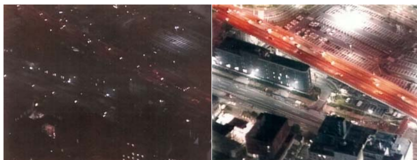
Рис. 3. Аэрофотографии ночного города, сделанные обычным видеоконом (слева) и видеоконом с лавинным умножением носителей заряда (справа)
