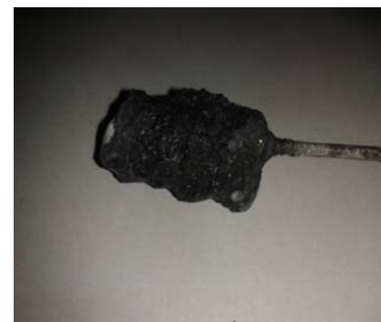
Рисунок 1. Металло-солевая груша интерметаллидов гольмия и никеля на вольфрамовом электроде
