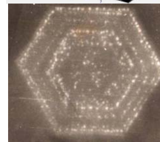
Фото 4. Выделение металлического серебра при освещении актиничным светом (автодекорирование МК бромистого серебра)
