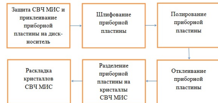
Рисунок 1. Блок-схема основных операций разработанного технологического маршрута разделения приборных пластин сапфира и карбида кремния на СВЧ МИС
