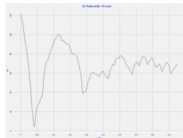
Рис. 1. Профиль пленки и глубина краевой линии, проведенной до поверхности подложки
