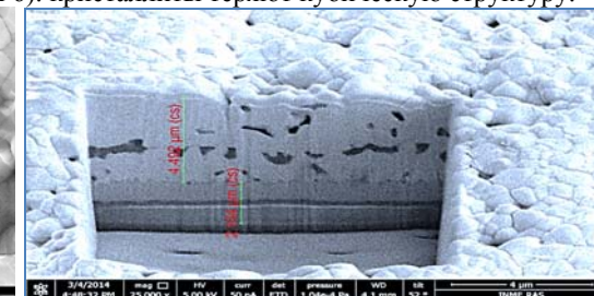
Рис. 6. Изображения сечения ФЧЭ, полученного физическим методом [5]
