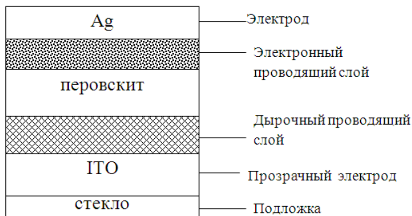
Рис. 1. Структура элемента преобразователя солнечной энергии в электрическую на основе металлоорганического перовскита
