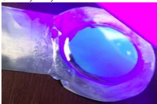
Рисунок 6 - Фотография образца № 4, изготовленного анодированием в ортофосфорной и щавелевой кислотах, после УФ- облучения
