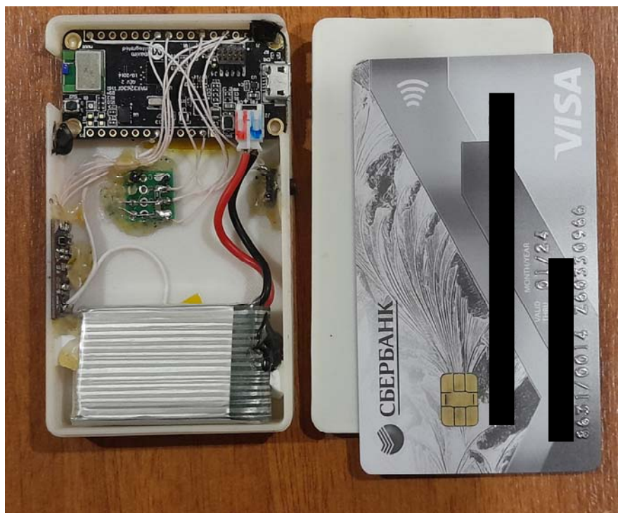
Рисунок 1 – Созданное устройство, включающее сенсоры ФПГ и ЭКГ MAX86150 и плату микроконтроллера MAX32630FTH. Справа для масштаба пластиковая карта
