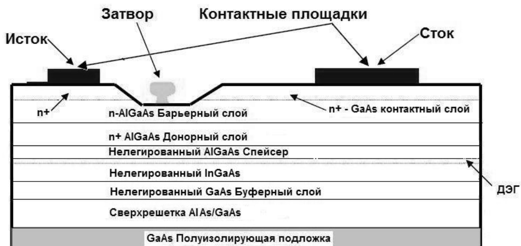
Рис. 1. GaAs pHEMT
