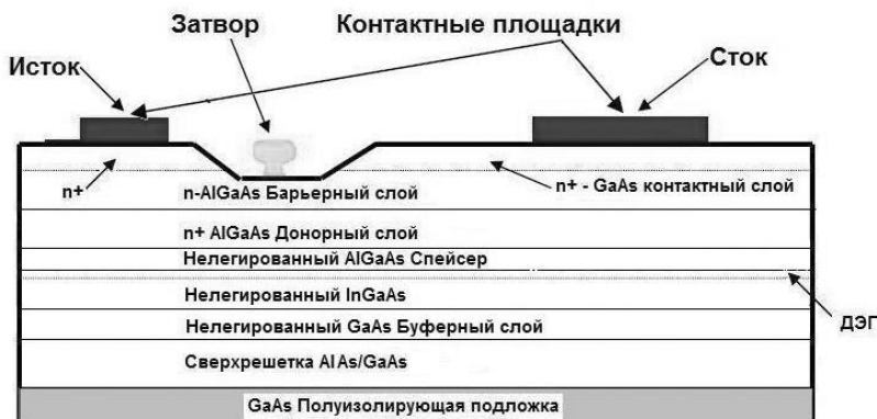
Рис. 1. Базовая конструкция рНЕМТ-транзистора
