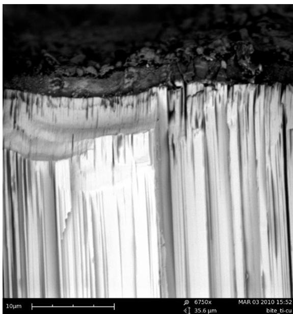
Рис. 2. Микроструктура поверхности слома полупроводниковой ветви с защитным покрытием Ti-Cu (увел. 6370 х )
